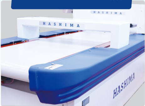
検針機HN-880CS センサーヘッド装備
